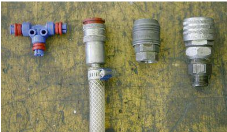
Figuur 13-4: Snelkoppelingen pneumatiek en tules
