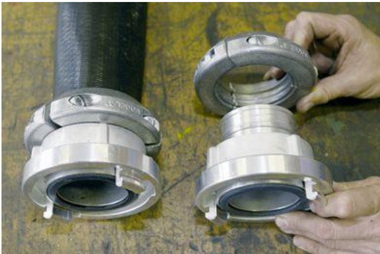
Figuur 13-2: De koppeling voor de slang van het sleepslangstelsel
